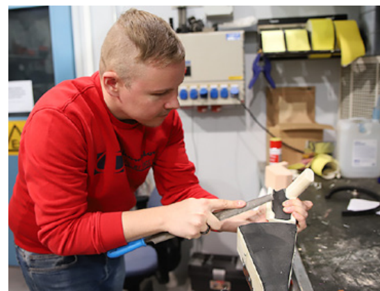
Industridesigneren Henri Hokkanen jobber med en plastmodell av et armlene. Mange plast-, tre- og 3D-trykte komponenter brukes for å lage modeller i full størrelse av fremtidige traktorer og førerhus.
