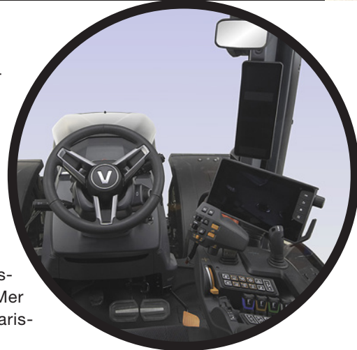
S-serien er tilgjengelig med TwinTrac-systemet med vendbar førerplass og PowerBoost gir full kraft til kraftuttaket også på de større modellene.
