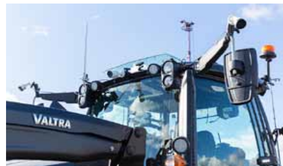
Kameraer montert på utsiden viser operatøren hva som skjer rundt traktoren.
