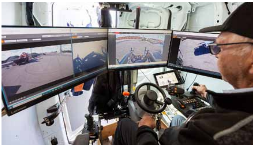
Traktorkontrollene er her plassert i en varebil. Det er også mulig å fjernstyre en traktor ved bruk av styringene i en annen traktor eller med flere begrensninger ved bruk av en bærbar styreenhet.
