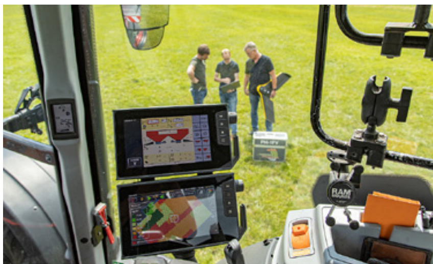
Høydekart og skanning av plantevekst brukes til å lage gjødslingsplaner. Den nedre delen av denne delen i blått har opplevd flom, noe som betyr at planteveksten der henger etter (gul-røde områder på NDVI-kartet). Det gjødsles hardere på de bedre stedene markert med grønt – der er det potensiale for høyest avkastning.
