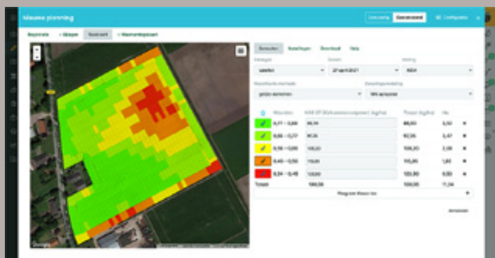
Høydekart og skanning av plantevekst brukes til å lage gjødslingsplaner. Den nedre delen av denne delen i blått har opplevd flom, noe som betyr at planteveksten der henger etter (gul-røde områder på NDVI-kartet). Det gjødsles hardere på de bedre stedene markert med grønt – der er det potensiale for høyest avkastning.
