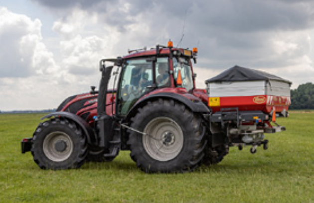
Thijssens Valtra T174 Direct har Michelin XeoBib dekk med dekktrykkregulering for å gi minimalt marktrykk.
