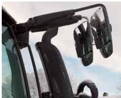
Opplæringstraktoren er utstyrt med ekstra pedaler og ekstra speil. Topp hastigheten kan enkelt justeres etter behov.
