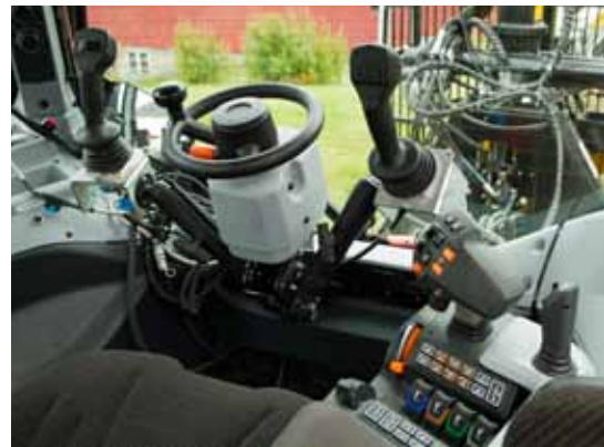
Med TwinTrac er det lett for Lervik å se når han bruker Kesla-kranen til å legge tømmerstokker på tømmerhengeren.
