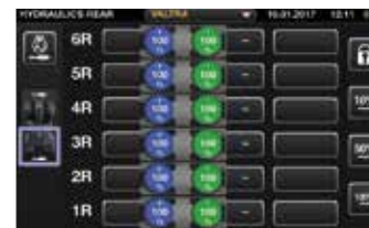
Du kan tildele en hvilken som helst kontroll for å betjene alle hydraulikkfunksjoner, inkludert hydraulikkventiler foran og bak, fronthydraulikk og frontlaster.
