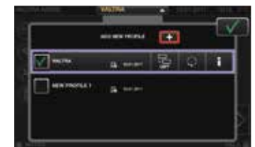
Profilen for fører og redskaper som enkelt kan endres fra en hvilken som helst skjermen. Alle innstillingsendringene vil bli lagret i den valgte profilen.
