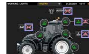
Konfigurer arbeidslysene enkelt med den 9-tommers berøringsskjermen. Premium og Premium+ arbeidslys omfatter også innstillbare svingelys som kontrolleres av hjulvinkelsensor på forakselen.
