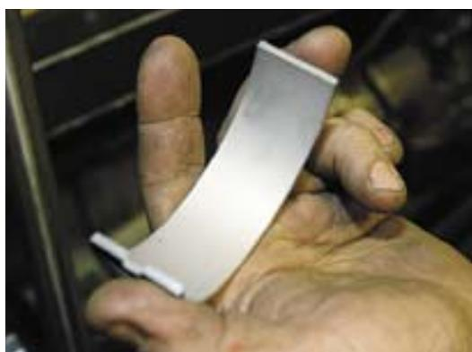
**Glidelageret som brukes i Valtra-traktorer har nå glatt overflate. Erfaringene fra pulling har vist at oljen flyter lettere hvis det ikke er separat oljekanal i lageroverflaten.**
