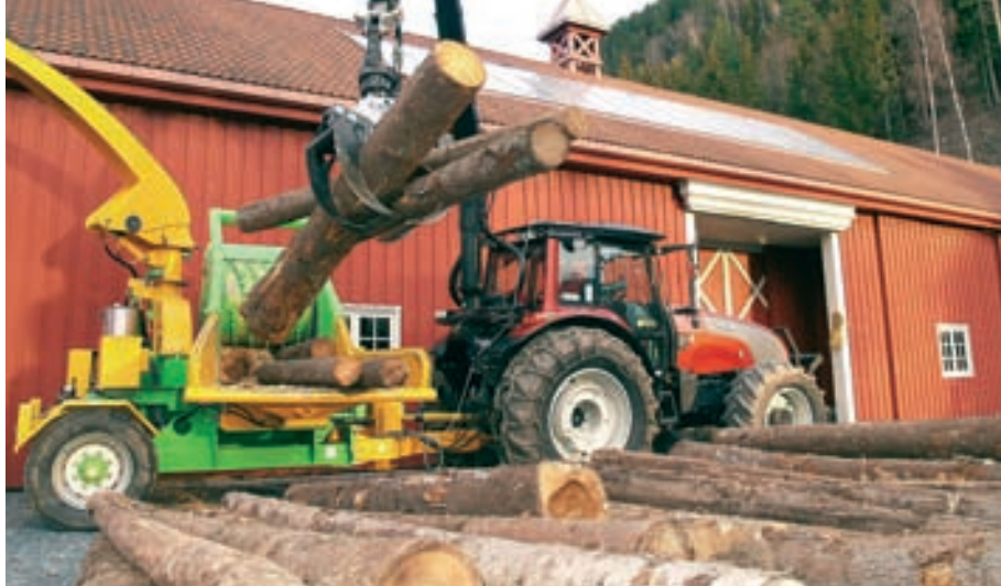
Drift av flishogger og tømmerkran med klo samtidig går fint. Etter Energigårdens erfaringer trengs det ei nokså sterk kran når aggregatet Nisula 280 E skal i bruk i småskog.
