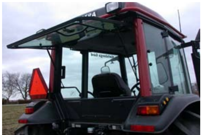
Greit: Sikten er viktig på en traktor i denne størrelsen. Bakruta er stor, men det finnes ingen nedre rute bak, og sikten ned mot trekkroken er begrenset.
