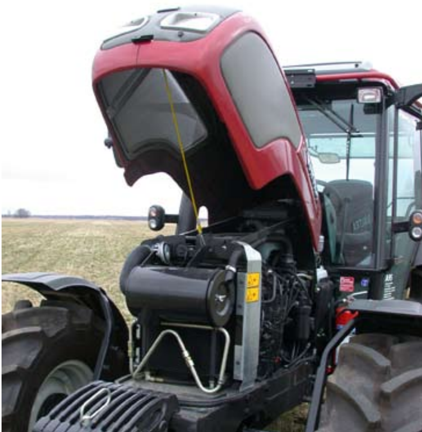
Tilgjengelig: Panseret på Valtra A95 åpnes i fronten og kommer opp i ett stykke. Det er veldig bra. Lengst fram sitter luftfilteret, lett å komme til.
