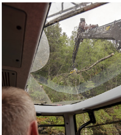
Begge Valtra-traktorene er utstyrt for skogsarbeid, inkludert solid glasstak, spesialtilpasset for kjøring i tett skog.
