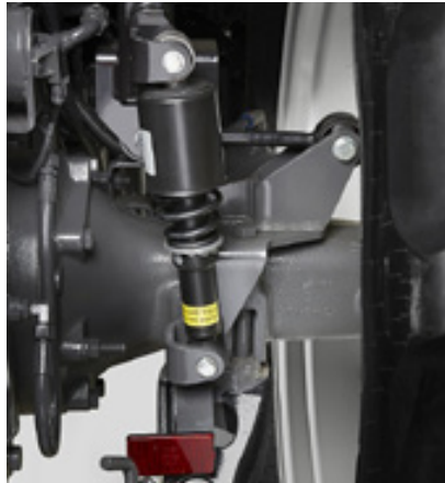
Den mekaniske førerhusfjæringen er justerbar og har doble Panhard-stag for å stabilisere førerhuset.
