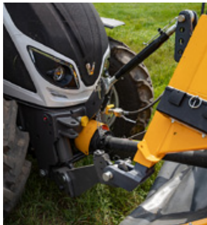
Den nye A-serien kan leveres med trepunktshydraulikk og kraftuttak foran fra Unlimited Studio.
