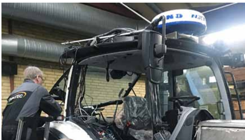
Valtra N154 er en flerbruksmaskin som kan utstyres med et bredt spekter av utstyr, inkludert en maritim radar, et infrarødt varmesøkende kamera og søkelys.
