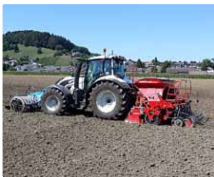
Såing med seksjonskontroll og variabel mengdekontroll.
