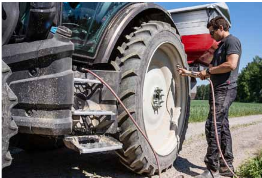
Den nye G-serien er tilgjengelig med en luftkompressor på siden av traktoren ved stigtrinnene, noe som gjør det enkelt å for eksempel justere dekktrykket.
