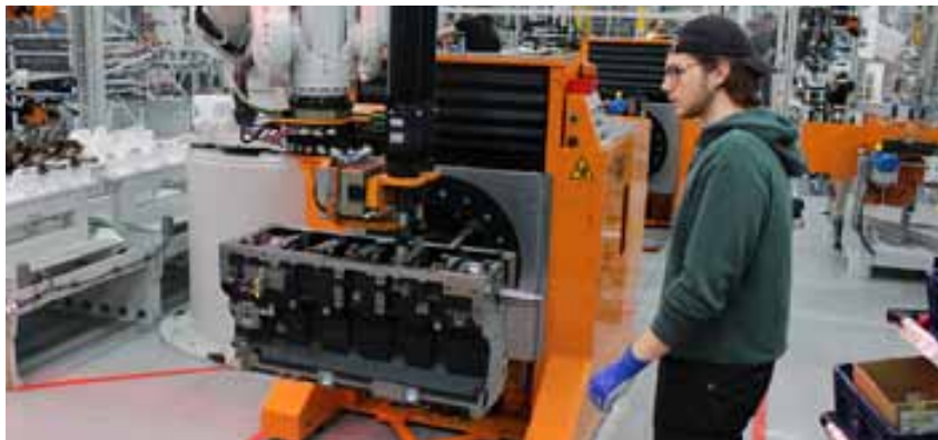
Mekaniker Julius Salmela monterer en veivaksel ved hjelp av en industrirobot.
